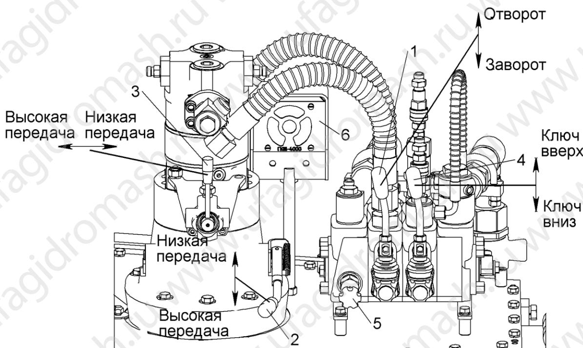
Рычаг управления коробкой передач поз. 2 позволяет выбирать высокую или низкую передачу. Рычаг управления четырехходовым клапаном поз. 3 также позволяет выбирать высокую или низкую передачу. Таким образом, получаются четыре различных параметра частоты вращения ротора и крутящего момента гидроключа (см. Таблица 1).
