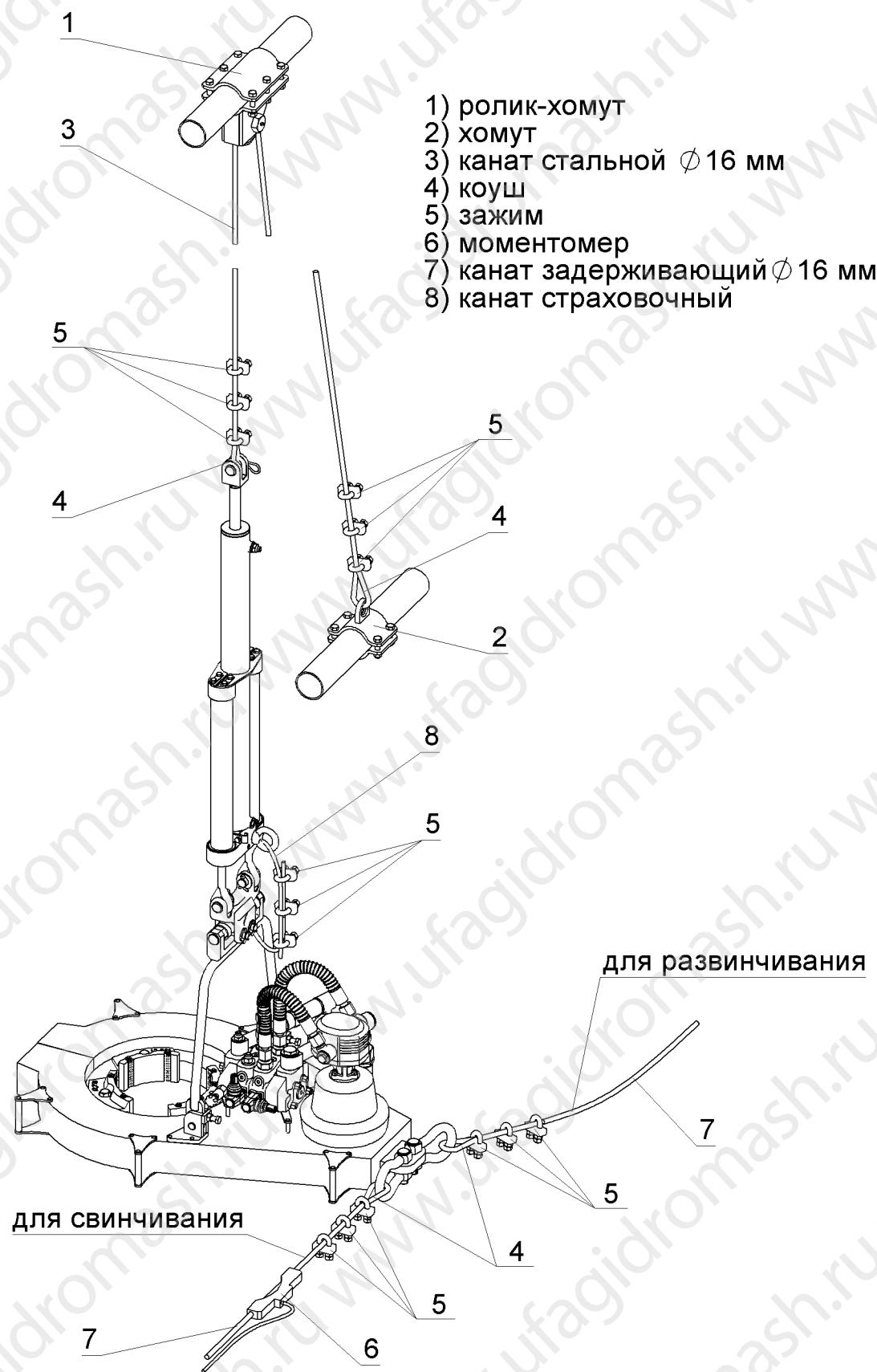
2.4.2. Присоединить задерживающие канаты к изделию горизонтально, т.е. они не должны тянуть изделие вверх или вниз, при этом угол в плане между осью натянутого каната и осью симметрии корпуса изделия должен быть  $90^\circ \pm 10^\circ$ .
